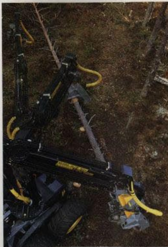
Stamförflyttning med HN125-kranen är snabb och exakt. Arbetsområdet sträcker sig från maskinen och tio meter ut.
