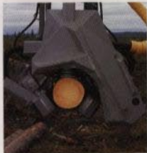
Mätningen görs i triangelformat för att kompensera eventuell ovalitet i stammen.
