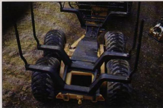
**STYRBAR VAGN** som alternativ ger 10-tons skotaren unika fördelar. Platsbehov och vändradie som den "lilla skotaren" men med bibeckanternas kapacitet. Vagnen har standard boggi vilket medger alla alternativa hjul-utrustningar. Även band kan monteras.
