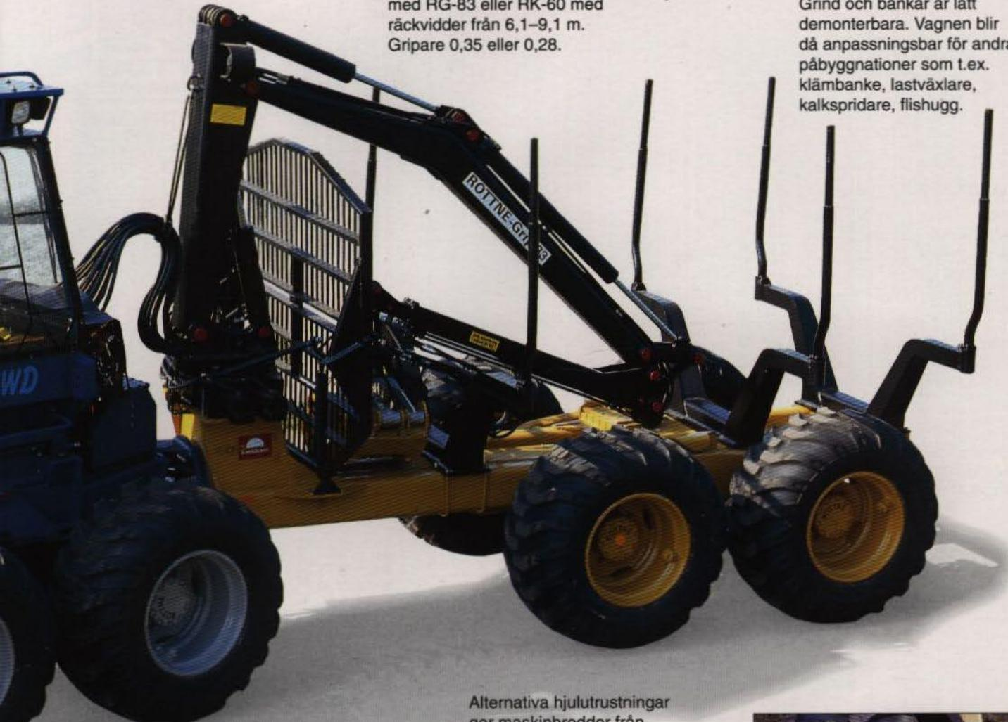
Alternativa hjulutrustningar ger maskinbredder från 2,35 m till 2,75 m.
