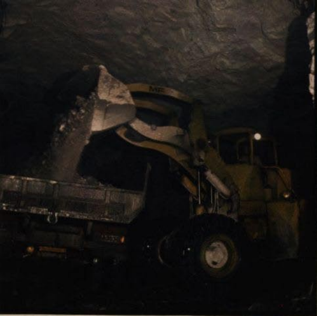
Det är trångt om utrymmet. Tunnelstorleken är anpassad efter maskinen och med jämna mellanrum finns nischer insprängda där lastningen kan ske.
