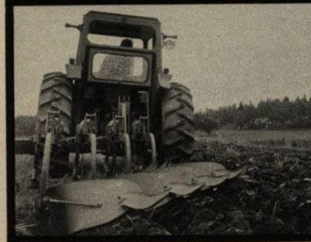
Bild sid 4. Den helautomatiska utlösningen är mekanisk. Den fungerar med hjälp av kraftiga spiralfjädrar.
