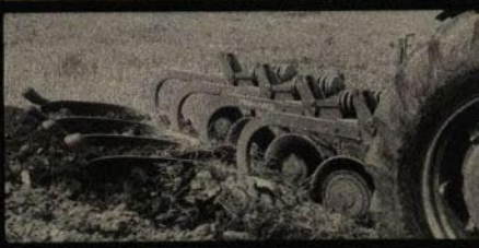
Bild sid 4. Den helautomatiska utlösningen är mekanisk. Den fungerar med hjälp av kraftiga spiralfjädrar.
