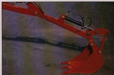
Grävtbyggnad och 50 cm skopa monterad på sticka.
