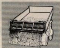
SANDSPRIDARE, eldriven från bilbatteriet
