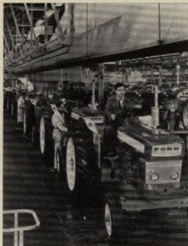
Sammanlagt 300 traktorer per dygn är kapaciteten för det nuvarande monteringsbandet i Basildon.
