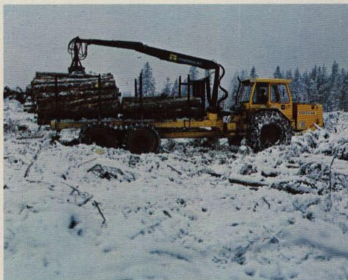
6 stora drivhjul ger lågt marktryck och en god fördelning av dragkraften.
